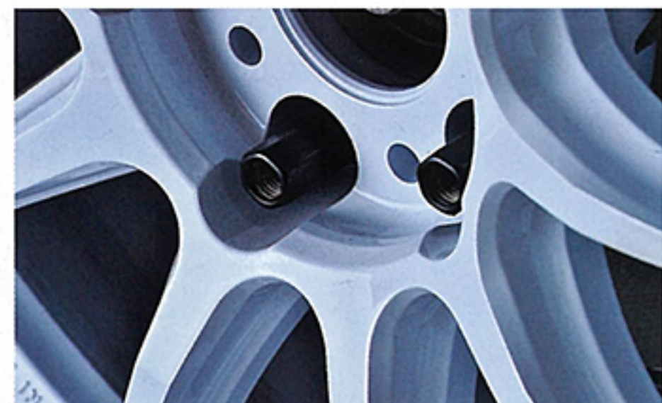
センターホール周辺にも軽量化へのこだわりが見受けられる。中央の窪みは、一般的にはハブ面に対し垂直になるが、ZR10はマイナスの角度にえぐられているのだ。スポーク部のラインもただ削るだけでなく、局面を巧みに使って剛性を確保。こういった数々の細かな工夫により、軽さと強さを両立させた。
