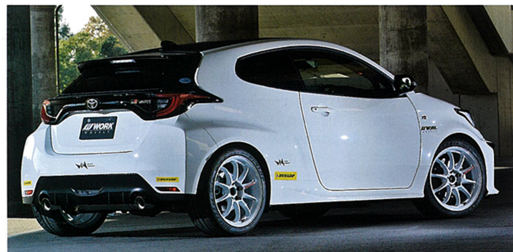
装着マシンは女子チームでラリーに参戦する、ウェルバインモータースポーツのGRヤリスRS。代表の松井さんによると「ラリーでのライバルは素のヤリス」だそうだが、タイヤ&ホイールに関しては純正で8J×18、225/40タイヤを履くGRヤリスにメリットがある。撮影車両は8.5Jと「純正超え」しているため、ラリー狙いではなくジムカーナ狙いとのこと。
