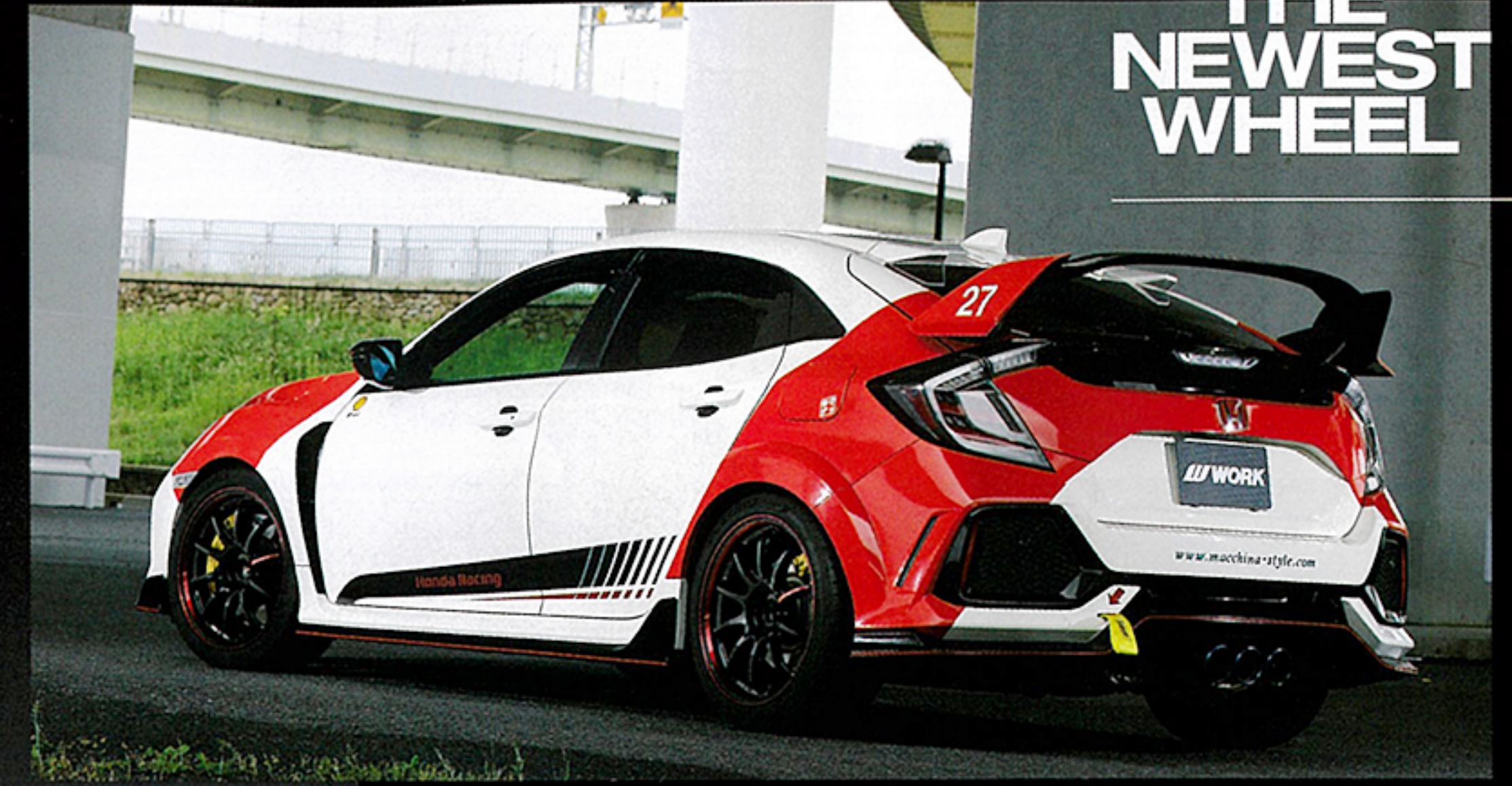
装着車両のシビックタイプR [FK8]は2台とも、大阪府にあるカスタムショップ、マキナのユーザーカーだ。装着するZR10 KURENAIはプロトモデルで、サイズは8.5Jx18+47。タイヤはミシュランパイロットスポーツ4Sで245/40R18。
