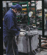
焼き入れ時に起こるディスクの変みを修正し、バリをとる。
