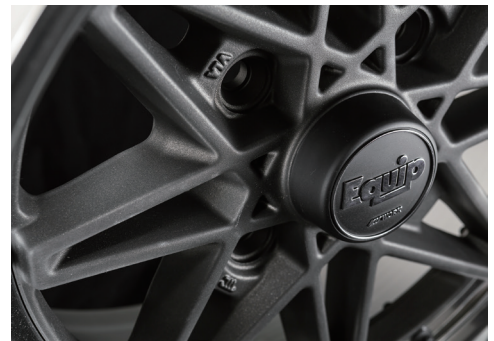
南部鉄とネーミングされたペイント方法。砂型を使っていたところにザラ目の質感を再現する特殊塗料を使用。マットブラックでは出せない質感に注目。
