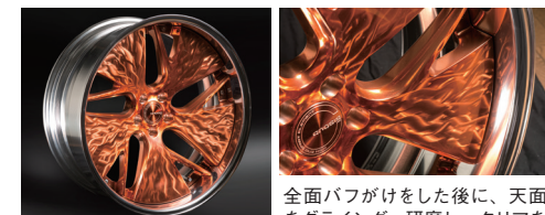
全面バフがけをした後に、天面をグラインダー研磨し、クリアをかけた後、銅パークリア塗装して完成。グラインダータトゥと側面のバフの輝き方の違いが美しい。
