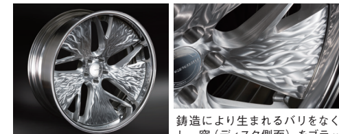
製造により生まれるバリをなくし、窓(ディスク側面)をブラッシュしてヘアライン風に仕上げた。その後、天面をグラインダー研磨し、最後にクリア塗装している。
