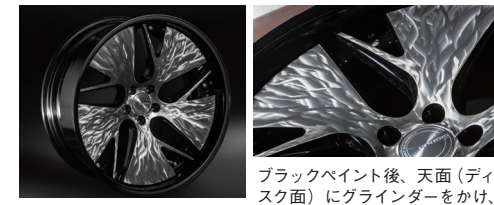
ブラックペイント後、天面(ディスク面)にグラインダーをかけ、さらにトップコートとして、グレークリアを吹きかけて仕上げた1本。ブラックリムとのコンビで、グラインダータトゥが怪しく光る。
