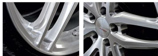
鍛造してから削っていくことで、軽量化と剛性アップを実現。鍛造製法ならではの硬質感とともに、繊細さも見せてくれている。5スターデザイン自体はコンサバティブなものなので、マッチさせやすいというのも魅力。
