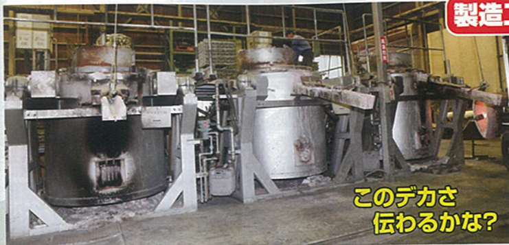
千原さんの横にあるのは取鍋。ここに溶湯（溶かしたアルミ）を移して次の工程となる。この取鍋に移す時の溶湯の温度も管理。取鍋自体もあらかじめ熱せられている
