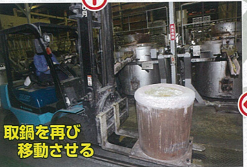
あらかじめ熱しておいた取鍋を溶解炉の前までフォークリフトで運び、この中に溶湯を移す。どうやって溶湯を取鍋に移すのかというと...
