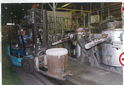
あらかじめ熱しておいた取鍋を溶解炉の前までフォークリフトで運び、この中に溶湯を移す。どうやって溶湯を取鍋に移すのかというと...
