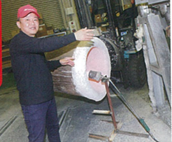
千原さんの横にあるのは取鍋。ここに溶湯（溶かしたアルミ）を移して次の工程となる。この取鍋に移す時の溶湯の温度も管理。取鍋自体もあらかじめ熱せられている
