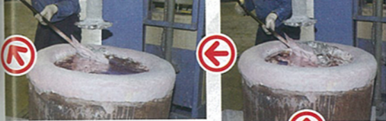
溶湯清浄装置に掛ける前に、まずは表面に浮いてきた不純物やゴミをすくい取っておく。シロウト目には、十分にキレイな材料に見えるけど...
