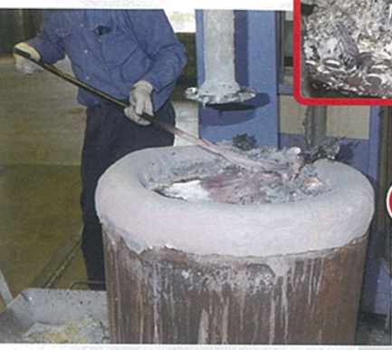
このように溶湯清浄装置をかけ終えた後は、再び表面に不純物が浮いた状態になっている。これらを丁寧に取り除き、溶湯中のガス量を真空ガスチェッカーで確認したら次の工程へ
