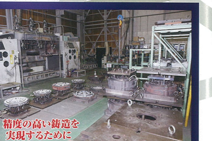
塗型をおこなうための専用スペース。現在おこなわれているエキップ40の次に使われる金型が用意されていた。塗型とは、鋳造時の素材整形を補い、製造性を向上させるためにおこなう金型へのコーティングのこと。手作業でおこなわれる
