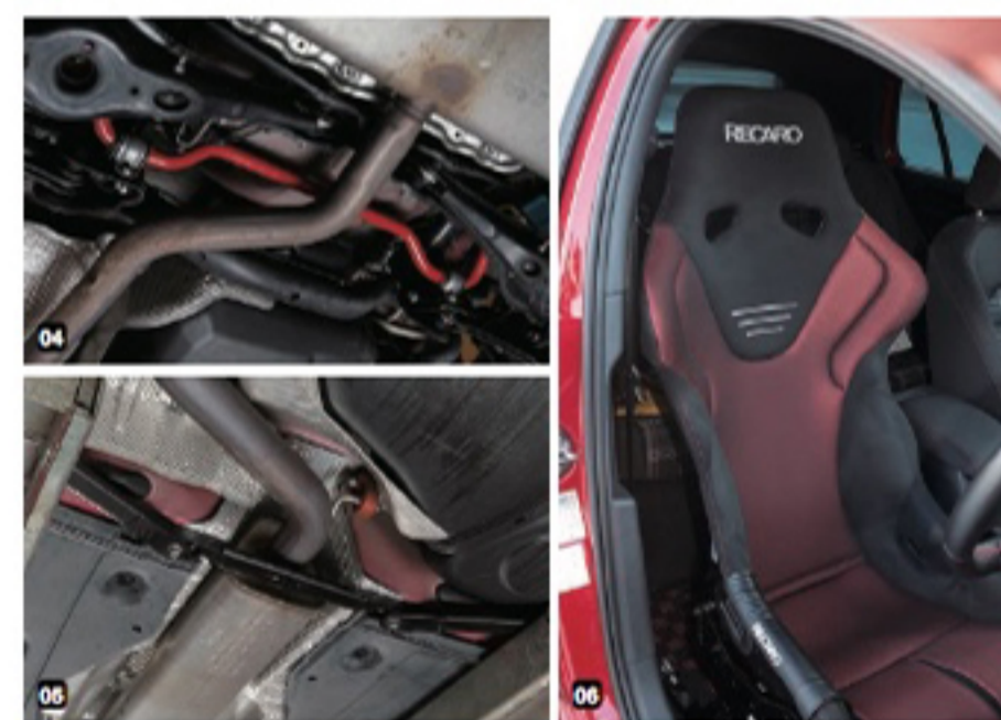
03_AWEチューニングのS-FLOエアインテークとAPRステージ1 ECUソフトウェアをインストール。 04_リアにセットされたニュースピードのスウェイバー。 05_cpmのロワーレイフォースメントはエクステンションを使ったステージ4でセット。サーキットも走れる仕様だ。 06_バケットシートはレカロRS-Gを運転席にセット。
