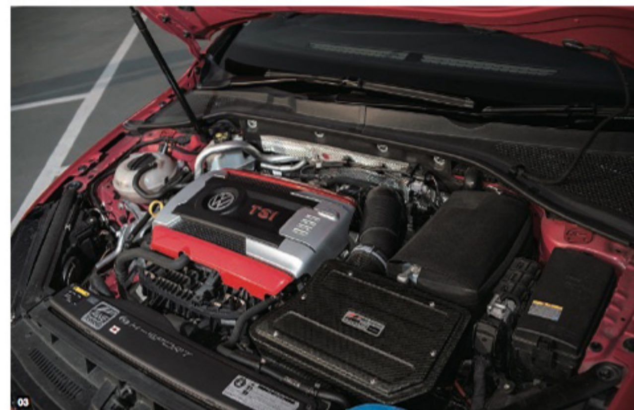
03_AWEチューニングのS-FLOエアインテークとAPRステージ1 ECUソフトウェアをインストール。 04_リアにセットされたニュースピードのスウェイバー。 05_cpmのロワーレイフォースメントはエクステンションを使ったステージ4でセット。サーキットも走れる仕様だ。 06_バケットシートはレカロRS-Gを運転席にセット。
