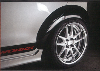
ワークは最大ブレーキキットにも対応するコンケイブ形状、オーバーステア40mm、また6本キャンバーを付けて195を履かせる。
