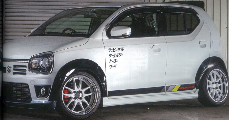
ワークは最大ブレーキキットにも対応するコンケイブ形状、オーバーステア40mm、また6本キャンバーを付けて195を履かせる。
