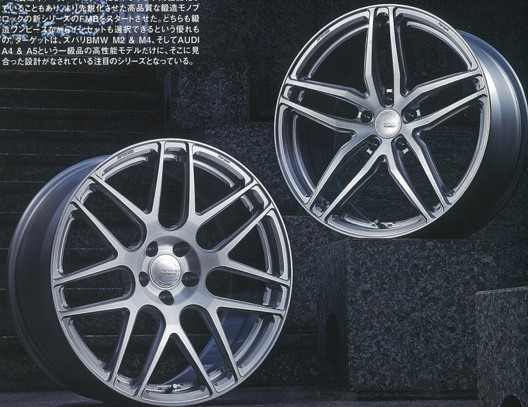
01. ディスク幅は十分に広まれている。コンケープの設定は、モデル、ディープ、ウルトラディープの3種類が用意される。02. スポーク自体も中央部がさくく削られており、徹底した軽量化がなされている。03. スポークの先端の接合部分にも肉抜き加工が施されており、軽量化にはさらなるこだわりを見せている。04. 鍛造ホイールであることを主張する「Forged」の文字が刻印されている。
