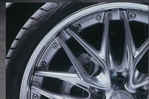
リアアウター側のホイールは、中心に3本のスポークが放射状に配置。スポークの端から中心部に向かって高低差がある立体的構造を備える。
