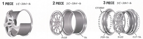
ホイールには、ディスクとリムが一体となっている1ピース(モノブロック)鍛造ホイールのほか、ディスクとリムに別れた2ピース、さらにリムがインナーとアウトナーに分かれ、ディスクをサンディッチする構造となる3ピースに分かれる。
