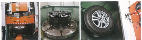
JAWA では、第三者機関による「衝撃試験」(写真左)、「回転疲労試験」(写真中央)、「半径方向負荷耐久試験」(写真右)の3つの強度試験を実施して合格品のVIA登録を進めている。他にも約20%以上以上の試験「JAWA 推奨強度試験」の検査を実施し、認定マシンの取得に成功している。
