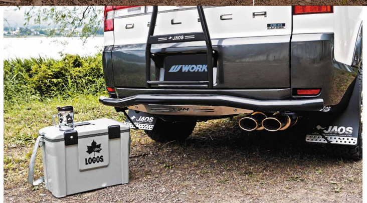
前ページでも触れた通り、今回の撮影に使用した車両は4WD・SUV 総合カスタムパーツメーカー「JAOS(ジャオス)」仕様のデリカ D:5。オリジナルのサスペンションキットのほか、バンパーを障害物から保護する役目を担うガードパイプ形状のスキッドバーがたくましさを増幅(同コンセプトのリヤスキッドバーも装着)。さらにサイドステップもパイプ形状でまとめている。カスタムの第一歩目としては、デリカ D:5 専用設計でボディにジャストフィット、泥ハネからボディを効果的に防ぐと共に、リアビューにワイルドなイメージを追加するマッドガードⅢがオススメ。現在、JAOSプロデュースのD:5はすでに完成型にあると言っても良いが、2016年末、高い人気を誇るリヤラダーにブラックモデルを追加するなど、進化はとどまらず!
