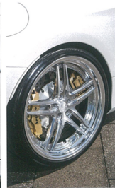
ノーマルでサイドブレーキキャリパーがあった部分には、ジュラルミンでサポートを作った8ピストンキャリパーをセット。またこの新しいブラケットをスタールで作ったサイドブレーキも付いて、よりダイナミックに稼働し、車高が下がっている仕様が通る。
