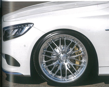
グーノス GR204とプレンボ8ピストンキャリパー(410mm ローター)のコンビネーションは、メカが狂っている仕様が通る。
