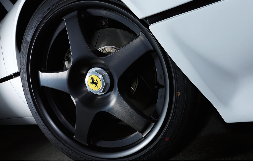
ワークのスペシャルオーダープログラム「シオン」によって実現化した、センターロックのホイール。
