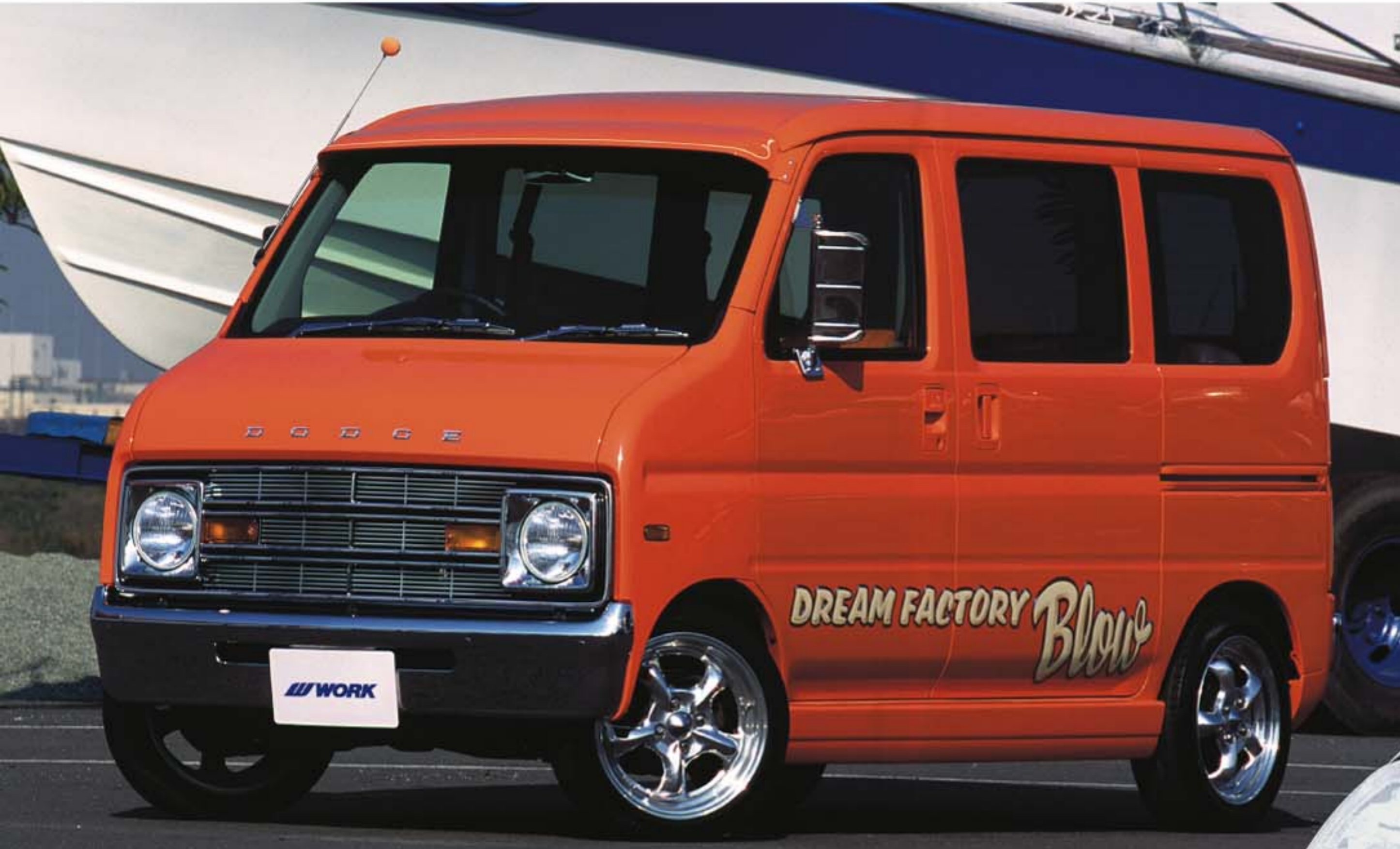
【SIZE】FRONT:15inchX5.5JJ OFFSET +42mm(O) TIRE:165/50-15 REAR:15inchX5.5JJ OFFSET +42mm(O) TIRE:165/50-15 COLOR:ワークメタルコート(WMC) ※ファンダー加工
